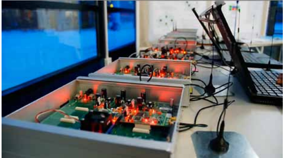
Viisi kuudesta WIFIUS-instituutin ensimmäisestä tutkimusprojektista toteutetaan Oulussa. Niitä yhdistää kognitiivinen radio, jonka kehittämisessä Oulu on kansainvälisessä kärjessä. Kuvassa CWC:ssä kehitetty kognitiiviradioiden testiverkko.
