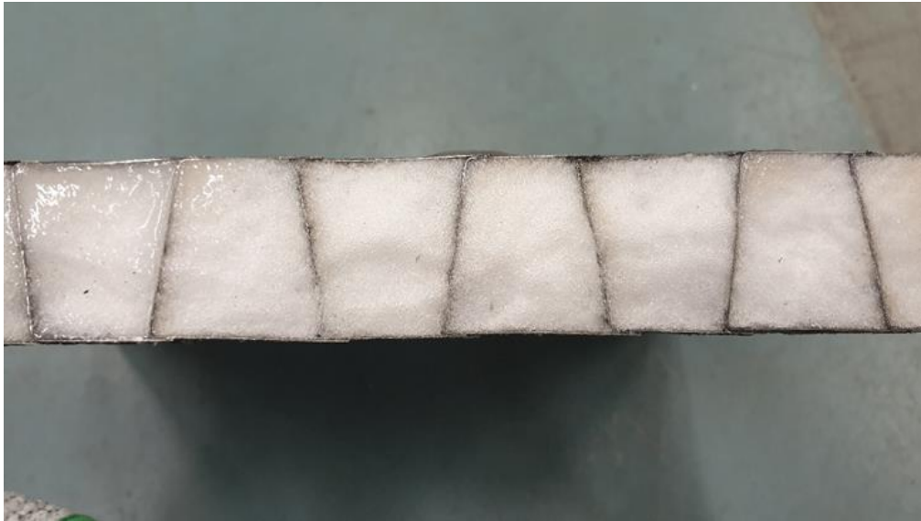
FMT-kennorakenne epoksivaaho täytteellä
