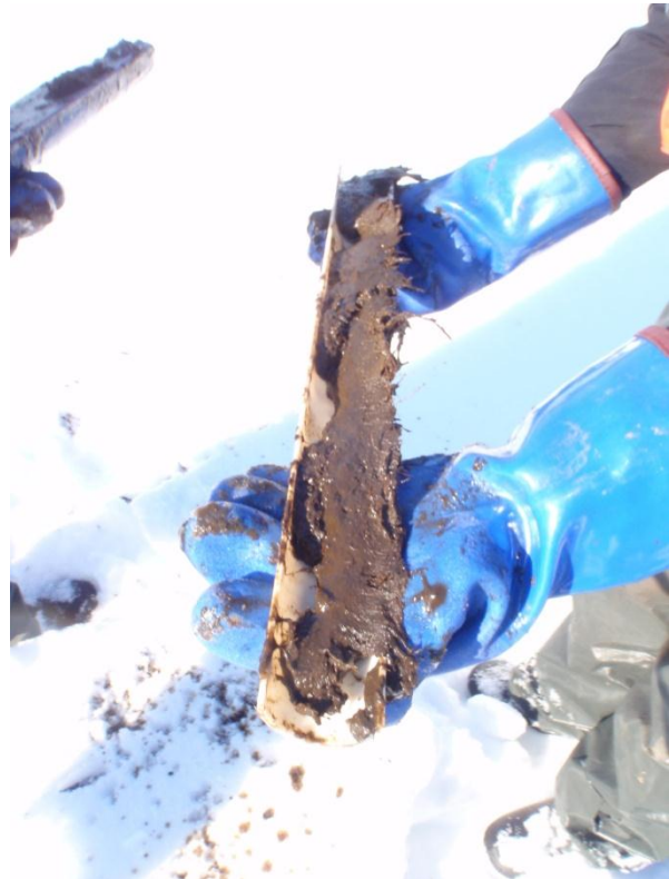
Kuva 25 Sedimenttinäytteenottoa Ahveroiselta. Kuvat P.Ala-aho.
