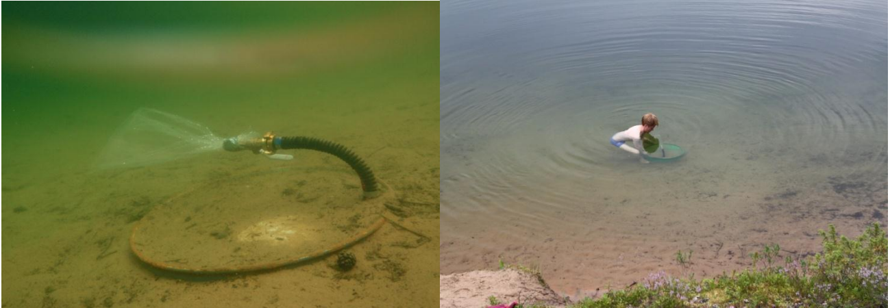
Kuva 28. Suotautumismittauslaitteisto (vas. kuva R. Eskelinen) ja laitteiston asennus (oik. kuva P. Rossi)
