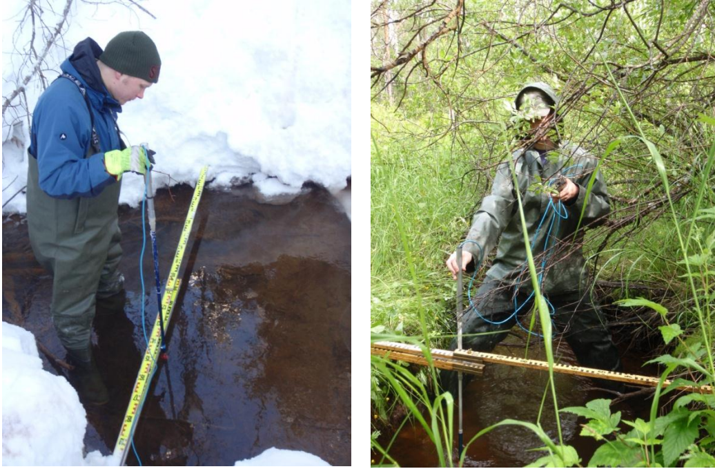
Kuva 20. Virtaamamittauksia talvella ja kesällä. Kuvat T.Reinikka ja V.Kupiainen.
