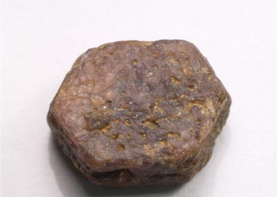
Kuva 8. Omamuotoinen korundikide, josta näkee hyvin korundin suhteellisen rapautumiskestävyyden. Herkemmin rapautuvat mineraalit ovat kuopalla tai kokonaan hävinneet. Näyte: Miessi-Ollila I9, Näytteen halkaisija 11 mm.
