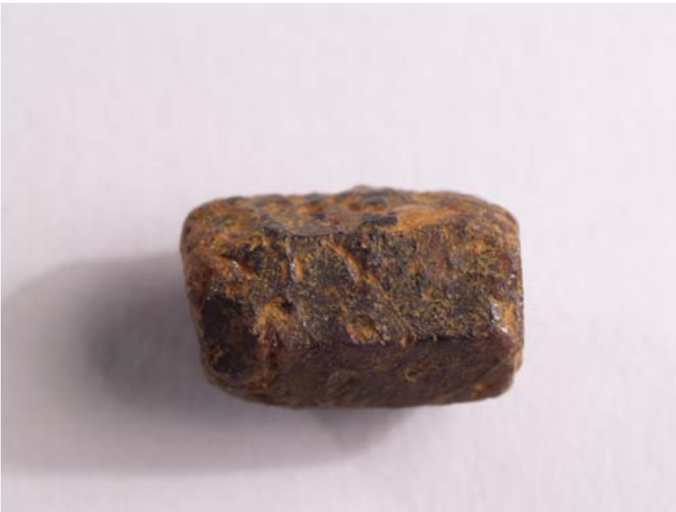
Kuva 3. Prismaattisen muotoinen korundi, jonka pinnasta herkemmin rapautuvat mineraalit kuluneet kuopalle. Näyte: Miessi, Marttila J1, näytteen halkaisija 9 mm.
