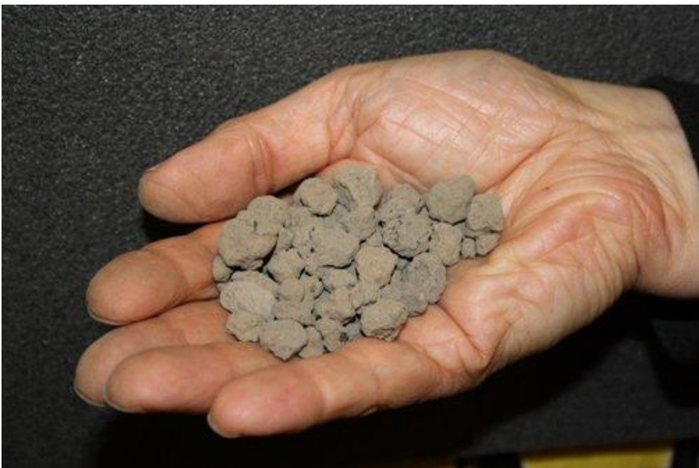
Ota vastaan meidän auttava kätemme, kuvassa pelletoitua symbioosituotetta (lentotuhkaa ja kuonaa) maarakenteisiin
