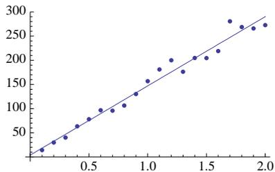
Sovitussuoran kulmakerroin on siis komponentin *konduktanssi*, resistanssin käänteisarvo:
